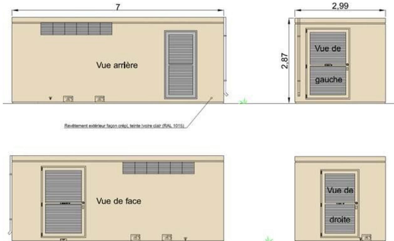
*Plan des façades et toiture des postes électriques du projet photovoltaïque*
